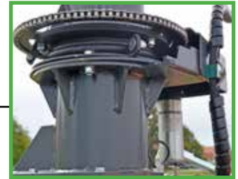
Sähköinen torven käntö Sähkämootorilla ja ketjuvedolla
